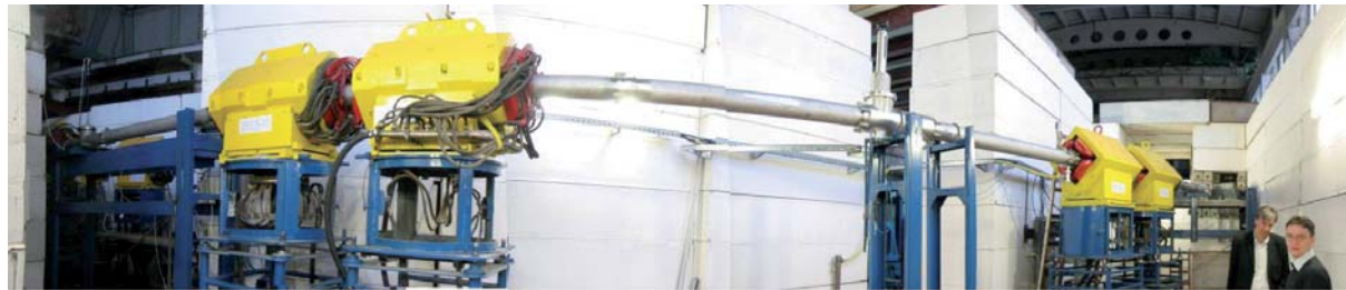
Протонный микроскоп, коэффициент увеличения изображения – 3.72 и 7.82
