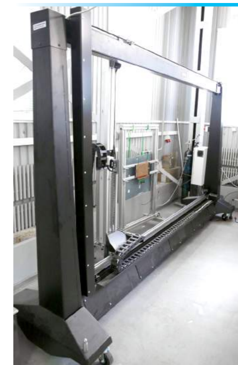
Общий вид собранного автоматизированного рентгеновского сканера первого типа
