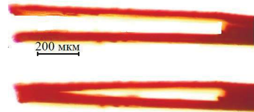
Внешний вид микрозахвата в разомкнутом и сомкнутом состоянии
