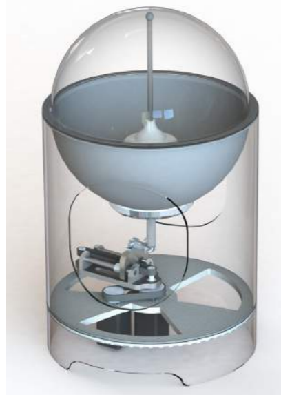
Модель универсального водного фантома для установки «Гамма-нож» нового поколения
