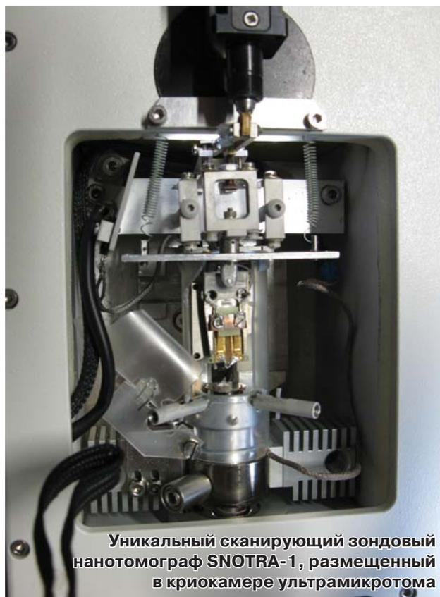
Уникальный сканирующий зондовый нанотомограф SNOTRA-1, размещенный в криокамере ультрамикротомы
