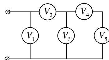
**Решение.** Ток через вольтметры 4 и 5 одинаков, а так как вольтметры одинаковы, у них одинаковое сопротивление, и, следовательно, на них одинаковое напряжение. А так как их показания одинаковы, они исправны.
