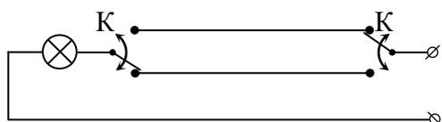
**5. (2 балла)** Известна цепь, в которой лампу можно включать и выключать любым из выключателей K1 и K2, причем независимо от положения второго (см. рисунок сле-
