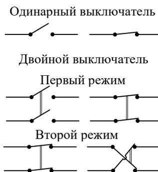
лей независимо от положения четырех остальных. Цепь должна состоять только из проводов и выключателей – одинарных или двойных (см. рисунок справа): одинарный выключатель соединяет или разывает один провод, двойной выключатель может работать в двух режимах: (1) одновременно соединять или разывать два провода двухпроводной линии, (2) одновременно переключать соединение двух проводов двухпроводной линии.
