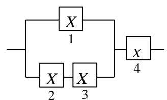
участок цепи, равна  $I$ . Тогда именно такой ток течет через элемент 4 -  $I_4 = I$ . Поэтому напряжение на нем равно
