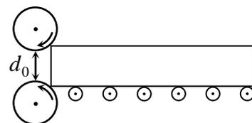
$d$  ( $d > d_0$ )? Заготовку не подталкивают. Благодаря каким силам происходит «прокатывание» заготовки между валками прокатного стана?
