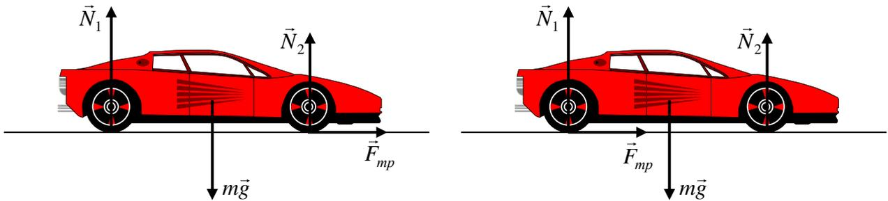
Поэтому, если центр тяжести машины находится точно посередине машины, расстояние между задними и передними колесами  $l$ , а высота центра тяжести над дорогой  $h$ , условие равенства нулю суммы моментов относительно центра тяжести дает (при условии, что машина движется, развивая максимальную мощность на максимуме силы трения)
