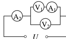
**Решение.** Так как вольтметры обладают одинаковым сопротивлением, то отношение напряжения на них равно отношению токов. Поэтому через вольтметр  $V_2$  течет ток  $I_1 U_2 / U_1$ . Поэтому ток, текущий через амперметр  $A_2$  равен
