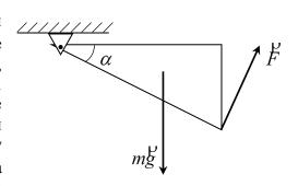
Для того чтобы найти силу F воспользуемся условием вторым равновесия. Причем моменты сил будем вычислять относительно шарнира — это позволит сделать момент неизвестной силы реакции шарнира равным нулю.
