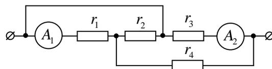
Известно, что амперметр  $A_1$  показывает силу тока  $I_1 = 1$  А. Найти показания второго амперметра, если  $r_1 = r$ ,  $r_2 = 2r$ ,  $r_3 = 3r$ ,  $r_4 = r$ .
