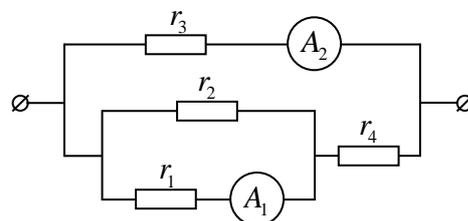
электрическая цепь может быть представлена в вид (см. рисунок). Сила тока, текущего через верхний участок цепи, состоящий из резистора  $r_3$  и амперметра  $A_2$ , равна
