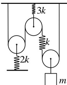
4. На какое расстояние переместится тело массой  $m$  в системе, показанной на рисунке, по сравнению с положением, в котором пружины не деформированы. Коэффициенты жесткости пружин показаны на рисунке, блоки невесомы, нити нерастяжимы.
