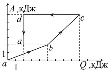
Дан график зависимости работы, совершенной газом с начала процесса, от количества теплоты, полученного газом с начала процесса. Качественно построить график зависимости давления газа от его объема в этом процессе и объяснить построение. Найти КПД процесса.
