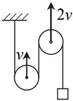
4. В системе, изображенной на рисунке, левый блок движется вверх со скоростью  $v$ , правый – вверх со скоростью  $2v$ . В каком направлении и с какой скоростью движется груз?
