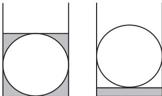
Кювета в разрезе, перпендикулярном высоте цилиндра, показана на рисунке, из которого заключаем, что объем налитой в кювету воды  $V$  равен разности объема параллелепипеда с основанием  $2R \times 2R$  и высотой  $h$ . Т.е.
