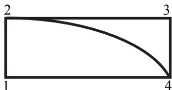
5. Имеется прямоугольник 1234, изготовленный из металлических стержней одинакового материала и одинакового сечения, причем длины сторон прямоугольника относятся как  $1-2 : 1-4 = 1:2$ . Вершины 2 и 4 связаны таким же (но кривым) стержнем с длиной, втрое большей длины стержня 1-2. Температуры вершин 1 и 3 поддерживаются постоянными и равными  $t_1 = 100\text{ }^\circ\text{C}$ ,  $t_3 = 0\text{ }^\circ\text{C}$ . Найти температуры вершин 2 и 4?
