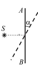
3. Точечный источник света  $S$  находится на расстоянии  $d = 15$  см от зеркала  $AB$  (см. рисунок). Зеркало вращается вокруг оси, перпендикулярной плоскости рисунка и проходящей через основание перпендикуляра, опущенного из источника на зеркало (через точку  $O$ ). Найти мгновенную скорость и мгновенное ускорение изображения источника в зеркале в тот момент, когда зеркало повернулось на угол  $\alpha = 30^\circ$  по сравнению с первоначальным положением.
