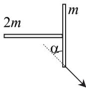
Палочки лежат на шероховатой горизонтальной поверхности (см. рисунок, вид сверху). К одному из концов палочки  $m$  привязана нить, за которую систему палочек медленно тянут по поверхности. Какой угол  $\alpha$  составляет палочка  $m$  с нитью.
