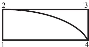
3. Имеется прямоугольник 1234, изготовленный из металлических стержней одинакового материала и одинакового сечения, причем длины сторон прямоугольника относятся как  $1-2 : 1-4 = 1:2$ . Вершины 2 и 4 связаны таким же (но кривым) стержнем с длиной, втрое большей длины стержня 1-2. Температуры вершин 1 и 3 поддерживаются постоянными и равными  $t_1 = 100^\circ, t_3 = 0^\circ \text{C}$ . Найти температуры вершин 2 и 4?
