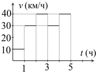
5. Автомобиль едет из одного города в другой со скоростью, зависимость которой от времени приведена на рисунке. Определить среднюю скорость автомобиля на одной пятой части пути.
