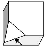
**Решение.** Очевидно, что в данном положении пластинка взаимодействует с вертикальными стенками угла только в одной точке. Действительно, треугольник может касаться своими сторонами граней угла только в единственном положении; если сдвинуть треугольник вниз на бесконечно малую величину контакт между стенками и сторонами
