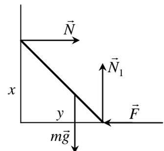
треугольника пропадет, и он будет опираться на ребро угла только своей вершиной. Следовательно, на треугольник действуют: две силы реакции - со стороны ребра и нижней грани угла, сила тяжести, приложенная к центру тяжести – точке пересечения медиан, искомая сила  $\vec{F}$ .
