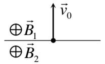
**Решение.** В верхнем и нижнем полупространствах частица будет двигаться по полуокружности с постоянной скоростью. Однако из-за неодинаковости индукций магнитного поля радиусы этих окружностей
