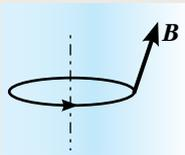
Найдём  $B_{\perp}$ . Используем выражение\* для индукции магнитного поля кольца на его оси на расстоянии  $x$  от его плоскости  $B = \frac{\mu_0}{2} \cdot \frac{I(2R)^2}{((2R)^2 + x^2)^{3/2}}$ ,
