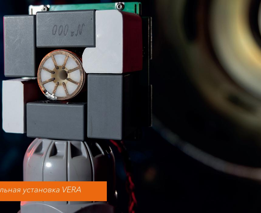
Плазменная двигательная установка VERA
