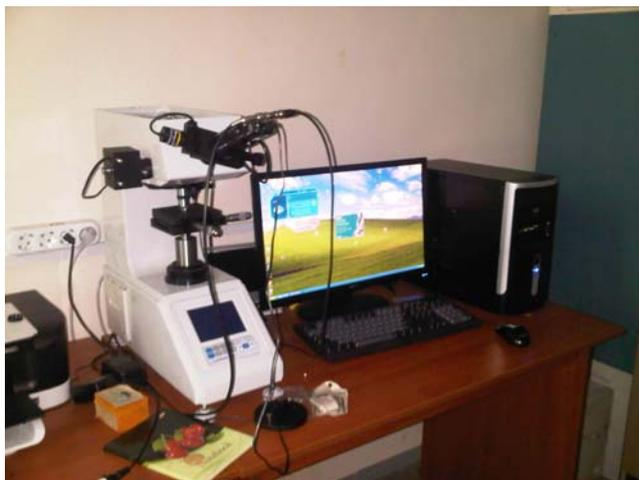
Диапазон измерений твердомера: 5-2000HV. Испытательная нагрузка твердомера HVS-1000: 10, 25, 50, 100, 200, 300, 500, 1000 гс (0.09807, 0.2452, 0.9807, 1,961, 2.942, 4.904, 9.807 N). Увеличение микроскопа твердомера: 500×, 125×. Точность измерений: ± 0,2 мкм (разрешающая способность микрометра 0,01 мкм). Расстояние от стола до наконечника: 75 мм. Размер координатного испытательного стола [X-Y] 100×100 мм. Ход координатного испытательного стола [X-Y] 25×25 мм.
