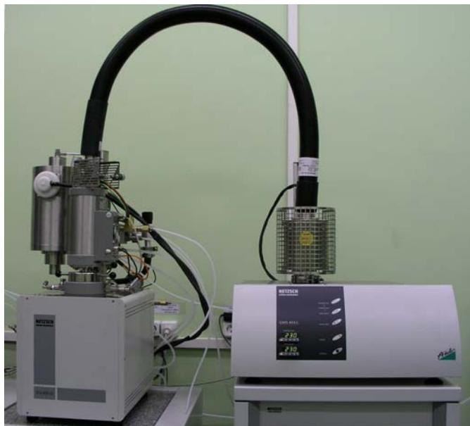
Температурный диапазон:  $T_{\text{комн.}} \dots 1700^{\circ}\text{C}$  (печь из Rh),  $T_{\text{комн.}} \dots 2000^{\circ}\text{C}$  (печь из графита). **Термогравиметрия:** разрешение – 5 мкг; масса образца – до 15 г; диапазон измерений – от 0 – 15 г; компенсация контролируется с помощью программного обеспечения.
