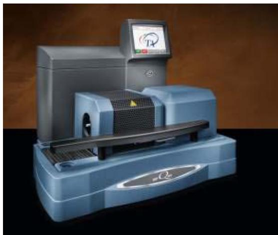
Комбинируя информацию ТГА и ДСК можно достаточно точно определить, является ли найденный тепловой эффект реакцией разложения, окисления или фазовым переходом. Высокая точность ДСК, ДТА и ТГА позволяет использовать прибор для определения теплот и температур фазовых переходов, изучения сложных смесей, анализа эластомеров, металлов, керамик, композитных материалов и многого другого.
