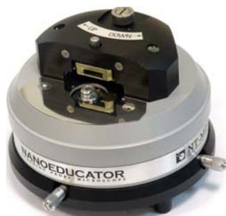
Учебный сканирующий зондовый микроскоп, направлен на освоение основ работы сканирующей зондовой микроскопии (СЗМ), приобретение навыков исследований нанообъектов и наноструктур, проведение зондовой нанолитографии. Позволяет реализовать различные методы измерений туннельной и «полуконтактной» атомно-силовой микроскопий (АСМ), может использоваться не только в учебных, но и в научных целях при исследованиях.
