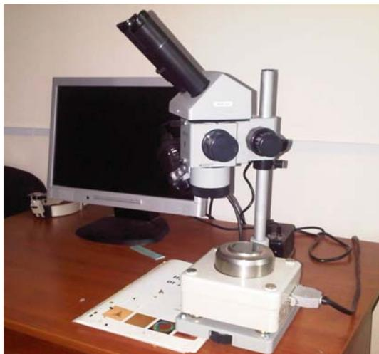
**Характеристики СММ-2000:** Область сканирования от  $5 \times 5 \text{ \AA}$  до  $2 \times 2 \text{ мкм}$ ; размер наблюдаемых объектов от 1 нм до 0,3 мкм; латеральное разрешение до 0,1  $\text{\AA}$ ; разрешение по высоте до 0,02  $\text{\AA}$ ; диапазон туннельного тока от 10 пА до 10 нА с точностью 5 пА; прикладываемое напряжение -5 В...+5 В, точность 1 мВ; размер образца до  $10 \times 12 \text{ мм}$ ; толщина образца от 0,4 мм до 1,5 мм.
