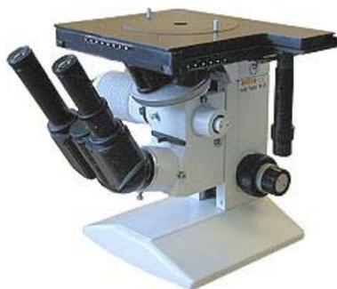
Увеличение: от  $\times 50$  до  $\times 1000$ . Диапазон перемещения предметного столика: в продольном направлении от 0 до 70 мм; в поперечном направлении от 100 до 150 мм. Цена деления шкал: предметного столика 1 мм; нониуса механизма 0,10 мм; микрометрической фокусировки 0,002 мм. Максимальная нагрузка 1 кг.
