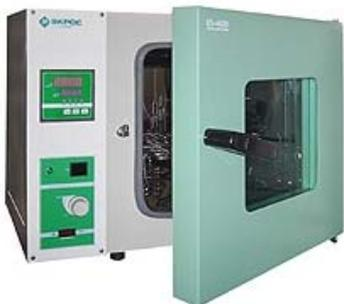
Рабочий диапазон температур от комнатной + 50 до 300°C; неравномерность температуры по объему  $\pm 1^\circ\text{C}$ ; дискретность температурной шкалы на дисплее  $\pm 0,1^\circ\text{C}$ ; количество полок в стандартной/максимальной комплектации 2/5 шт; потребляемая мощность 1100 Вт; объем камеры 58 литров.
