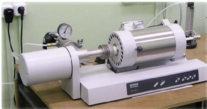
**Измерения изменения длины**  $\pm 2.5$  мм,  $\pm 5$  мм. **Чувствительность** 1,25 нм/ разряд. **Контактное давление** 15-45 сН, стандарт: 25 сН.
