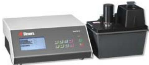
Комплект состоит из контрольного и полировального блоков. Контроль за утонением образцов производится автоматически фотоэлементом, процесс поступления электролита осуществляется с помощью помпы.
