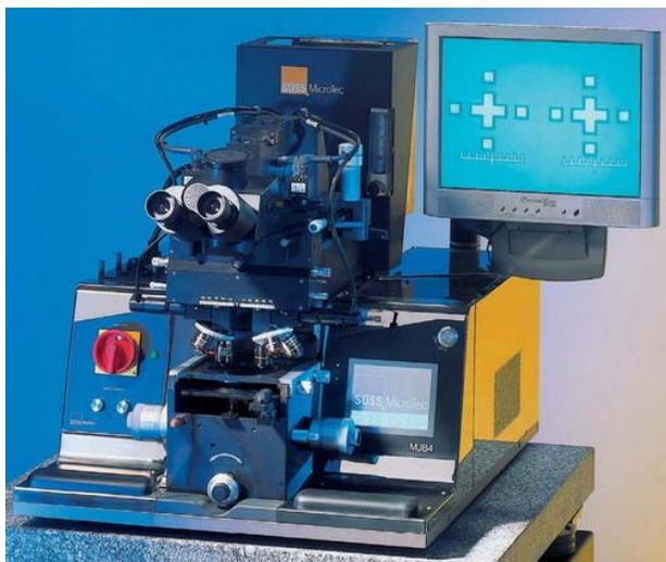
Экспонирование высокого разрешения – до 0,5 микрон. Размер обработки пластин и подложек - до 100 мм диаметром (пластины) и до 100×100 мм (подложки). Специальные держатели для кусков пластин, А<sup>III</sup>Б<sup>V</sup>, толстых подложек, гибридных схем и ВЧ. Высокоточная юстировка на плоскости и манипулятора микроскопа. Возможность конфигураций оптики интенсивной УФ и экспозиций с длиной волны до 80 мВт/см<sup>2</sup>.
