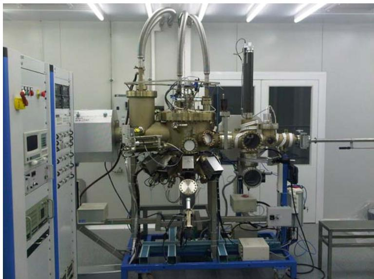
Установка состоит из 3-х вакуумных камер: камера роста, камера подготовки, камера загрузки. Все камеры оснащены системами безмаслянной откачки и разделены между собой высоковакуумными затворами.
