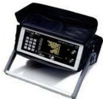
Диапазон частоты: от 1,0 до 10,0 МГц; Количество каналов контроля 8 шт. Максимальное усиление (по каждому каналу) 90 дБ. Дискретность регистрации: датчика пути 1 мм, параметров дефекта 1 мм; толщины 0,1 мм. Измерение параметров дефекта сварного шва с погрешностью: по длине  $\pm 1$  мм; по глубине развития  $\pm 0,5$  мм. Определение координат дефекта вдоль шва с погрешностью от пройденного пути не более 1 %. Минимально выявляемый дефект 0,8 ... 1,0 мм.
