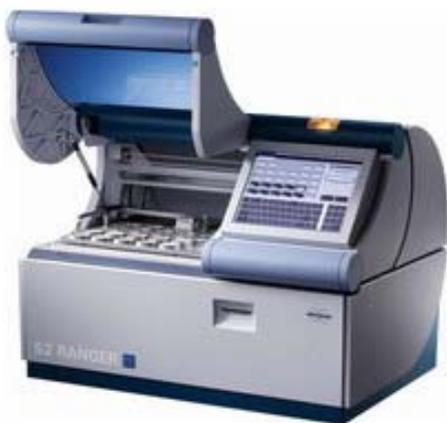
Питание: 220 В, 50 Гц. Потребляемая мощность 1 кВт. Источник излучения: рентгеновская трубка: мощность 50 Вт, ток до 2 мА, напряжение до 50 кВ.
