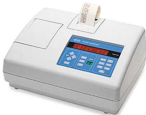
Принцип действия - нефелометрический прямой (90°) и относительный (ratio).
