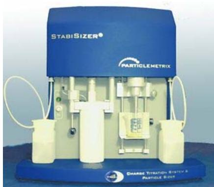
Применяется для водных растворов полиэлектролитов, коллоидных систем, суспензий, эмульсий.
