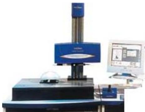
Прибор, предназначенный для анализа формы плоских поверхностей, таких как подложки, в полупроводниковом производстве.
