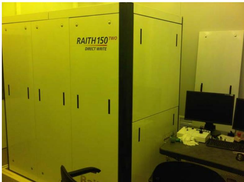
Установка электронно-лучевой нанолитографии на основе автоэмиссионного растрового электронного микроскопа Raith 150 TWO предназначена как для электронной растровой микроскопии высокого разрешения (не хуже 2 - 5 нм), так и для проведения нанолитографии с размерами получаемых элементов не хуже 15-20 нм.
