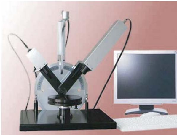
Эллипсометр позволяет измерять толщину слоев, получать для каждого слоя зависимости коэффициентов рефракции и экстинкции от частоты света, а также вычислять специфические параметры, например, ширину запрещенной зоны для полупроводников. Программное обеспечение позволяет проводить моделирование и получать значения пористости слоев, степень их кристалличности, толщину шероховатого слоя на поверхности.
