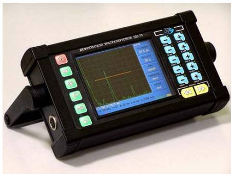
Диапазон толщин контролируемого материала (по стали) от 2 до 5000 мм. Рабочие частоты 0,4; 1,25; 1,8; 2,5; 5,0; 10,0 МГц Частота зондирующих импульсов 30; 60; 120; 250; 500; 1000 Гц Полярность зондирующего импульса отрицательная Амплитуда зондирующего импульса на нагрузке 50 Ом не менее 180 В. Длительность зондирующего импульса не более 80 нс. Диапазон измерения глубины залегания дефектов (по стали) 2 ... 5000 мм. Дискретность измерения глужи-
