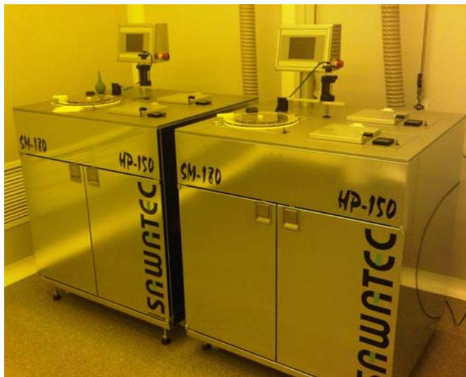
Система состоит из лабораторной центрифуги (SM180) и температурного столика (HP150). **Характеристики SM180:** Вставляемый модуль для сушки позволяет обрабатывать подложки до 150 мм диаметром; возможен как вакуумный зажим подложки, так и механический; до 10 пар установок скорость/время; имеет скорость 10 000 об/мин, укомплектована крышкой и чашей из полиоксиметилена (пластика). Скорость вращения 0-10 000 об/мин, точность вращения  $\pm 1$  на 6000 об/мин. Ускорение 80-500 рад/с<sup>2</sup>.
