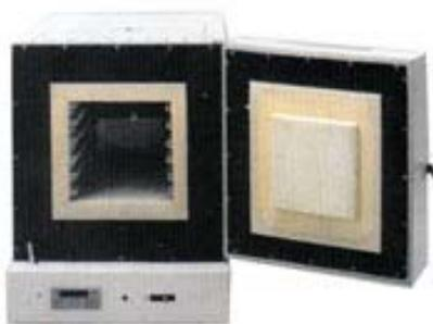
Максимальная температура нагрева 1100°C. Стабильность поддержания температуры ±4°C. Мощность, не более 3,4 кВт. Размеры камеры, 300×450×300 мм. Материал камеры волокно.
