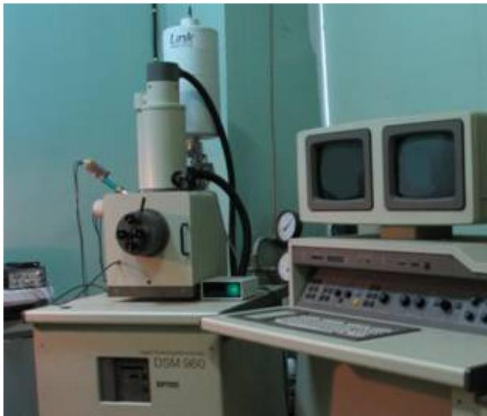
**Основные параметры комплекса.** Растровая электронная микроскопия (РЭМ): чувствительность  $S \sim 0,1 \%$ , разрешение по поверхности  $L_s \sim 100$  нм, разрешение по глубине  $L_h \sim 1$  мкм; ускоряющее напряжение 2-25 кВ.
