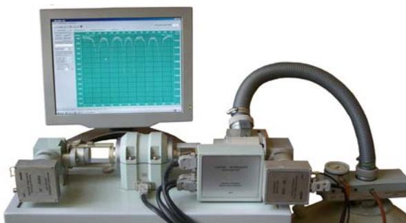
1. Значения скоростей перемещения поглотителя: от  $\pm 0,4$  мм/с до  $\pm 40$  мм/с. Максимальное отклонение скорости перемещения поглотителя на рабочем участке от линейного закона ее изменения для треугольного и пилообразного режимов движения должно быть:
