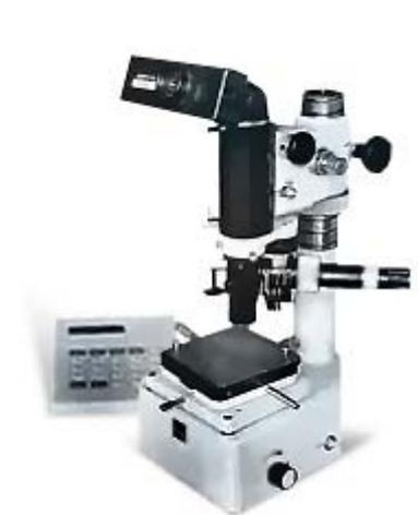
Предназначен для измерения микротвердости (по Виккерсу с квадратным основанием четырехгранной пирамиды с углом при вершине 136°), обеспечивает геометрическое и механическое подобие отпечатков по мере углубления индентора под действием нагрузки. Испытательные нагрузки ( $P_{гр}$ ) от 0,002 до 0,500 Гс. Пределы измерения микротвердости по Виккерсу  $8 \div 1300 \text{ кг/мм}^2$ . Погрешность измерения - 2%.
